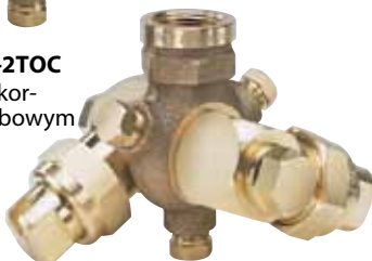
Typ 4629-3/4-TOC z pojedynczym korpusem przegubowym i połączeniem z rurą 3/4" NPT (gwint wewnętrzny). Mosiądz.
